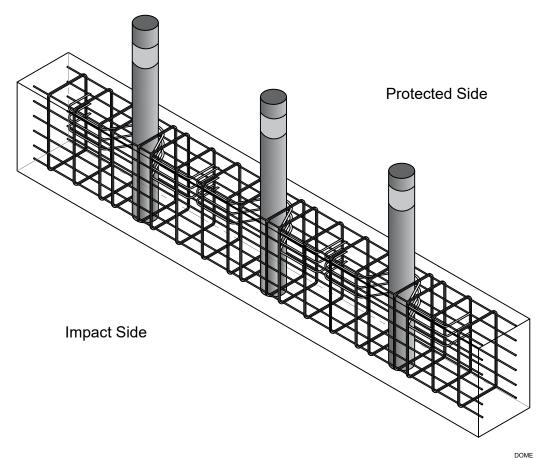
SPECIFICATIONS HEIGHT: 42" DIAMETER: 8.65" WALL THICKNESS: 0.500"
