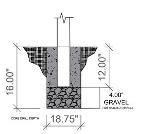
CORE DRILL MINIMUM DIAMETER
